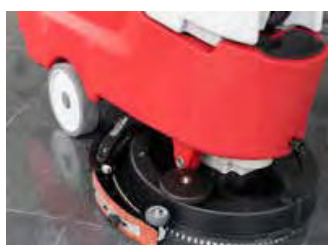
Saugbalken schwenkt automatisch in die Arbeitsrichtung
