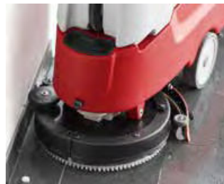
Gummierte Abweisrolle ermöglicht eine randnahe und sichere Reinigung
